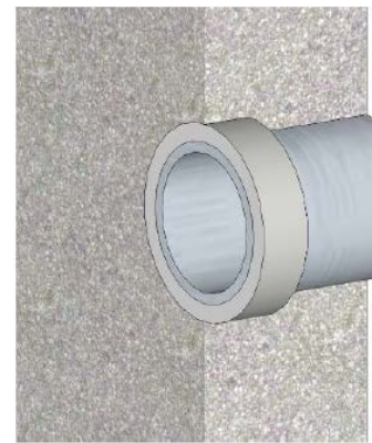
穿墙管道的防水施工
