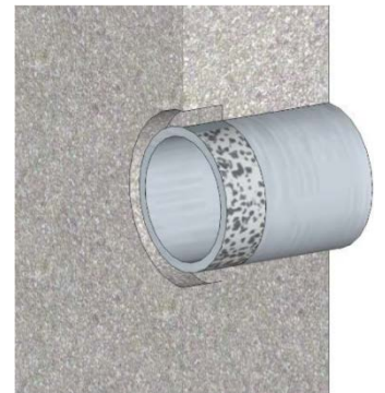
穿墙管道的防水施工
