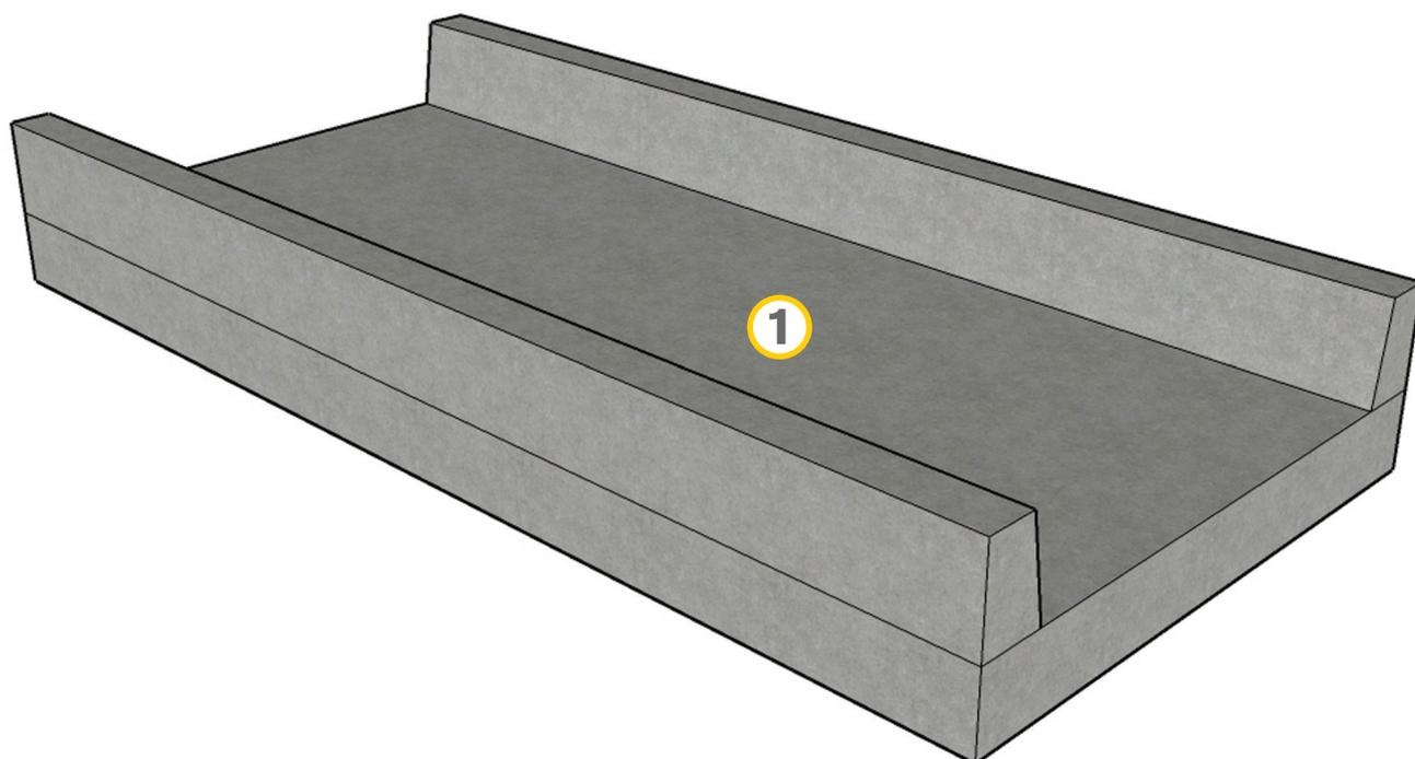
1. 使用凯顿公司的KIM混凝土防水外加剂直接添加到桥面混凝土中用于防水施工，还能有效防止融雪剂的破坏。工艺详情请参看应用指南1.11-1.15——KIM混凝土防水外加剂的施工。（注意：桥面施工时应预留出合适的伸缩缝）。
