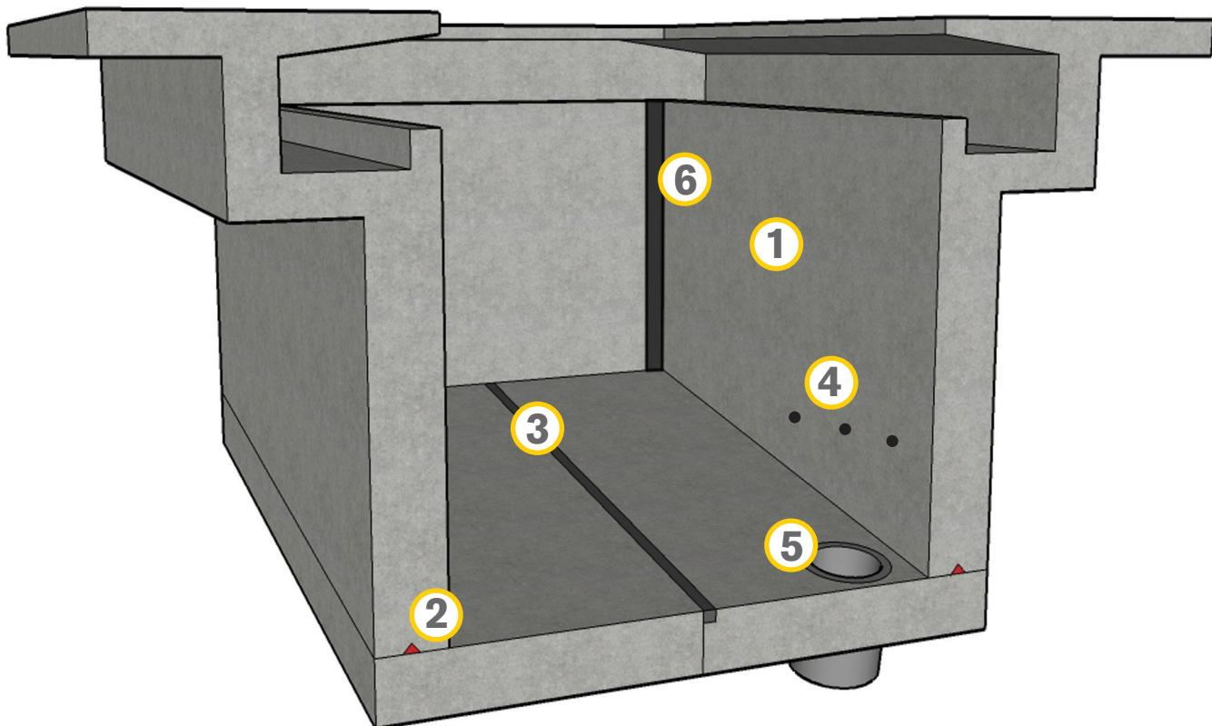
1. 使用凯顿公司的**KIM**混凝土防水外加剂直接添加到板和墙的混凝土中用于防水施工，全面保护建筑物内水不被外来污染物的浸蚀。工艺详情请参看应用指南**1.11-1.15——KIM混凝土防水外加剂的施工**。
